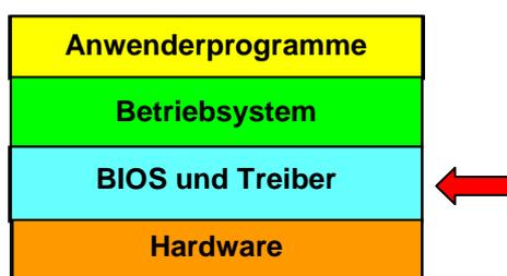
Anwenderprogramme haben in der Regel mit den Treibern nichts zu tun. BIOS und Treiber bilden eine Schicht zwischen Hardware und Betriebssystem. Sie liefern dem Betriebssystem das Wissen zum Steuern der Hardwarekomponenten und der Peripheriegeräte.
